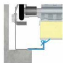
Joints doubles lèvres permettant une réduction des écoinçons et de la retombée de linteau nécessaires
