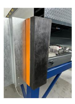
Flottants en hauteur (+150 mm / -90 mm par rapport au niveau du quai), complets avec visserie. Adaptés pour ajuster la hauteur afin de suivre les mouvements des conteneurs mobiles et/ou des véhicules spéciaux lors de l'accostage.
