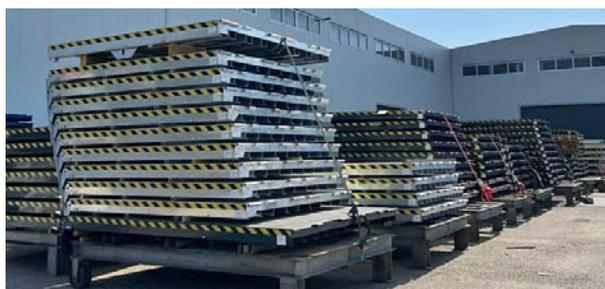
**Transport:** jusqu'à 6 - 10 (en fonction du type) niveleurs peuvent être empilés sur le plancher, avec une hauteur de charge de 160 mm x 6 (10). Pour les calculs de fret, la longueur brut des niveleurs lèvre basculant, y compris les lèvres pliés, est de 150 mm en plus que la longueur de la plate-forme du niveleur de quai.
