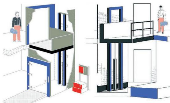
Nos monte-charges à colonne double sont conformes à la directive machine 2006/42/CE. Interdits au transport de personnes, ils sont conçus pour l'élévation de charges entre plusieurs niveaux fixes.
